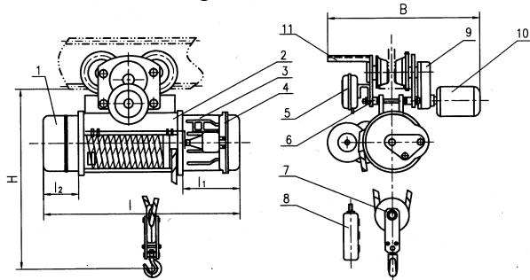
1. редуктор скорости подъемного механизма;
