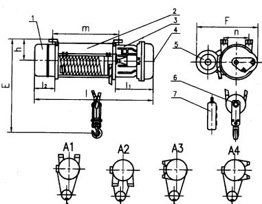
1. редуктор скорости подъемного механизма;
