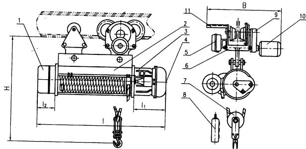
1. редуктор скорости подъемного механизма;
