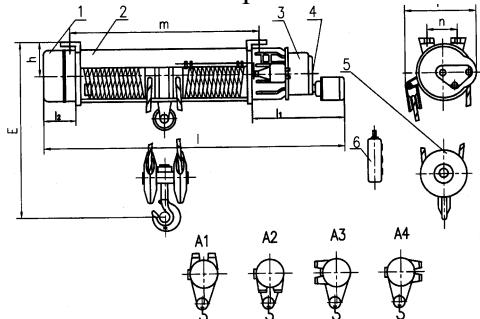
1. редуктор скорости подъемного механизма;
