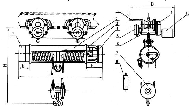
1. редуктор скорости подъемного механизма;
