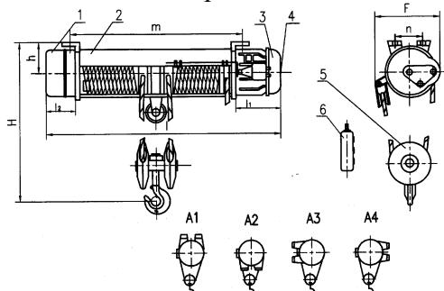
1. редуктор скорости подъемного механизма;
