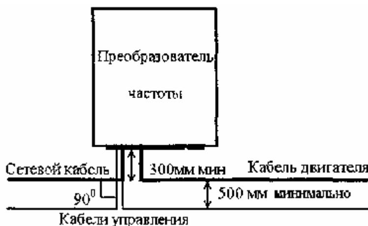
Рис. 15 Схема монтажа преобразователя частоты
